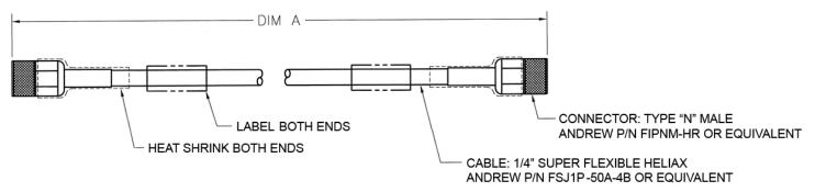
Figure A-5. 1/4" Heliax Coaxial Cable (CEFD P/N CA/3722-X)
